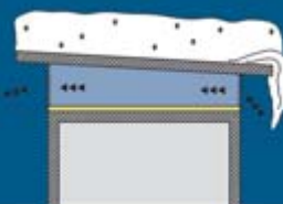
04| Dvoupplášťová plochá větraná střeška pultového tvaru s přesahujícími okraji s přímým odvodněním na terén
