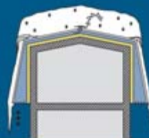
08| Dvouplášťová větraná střecha s kombinovaným sklonem vnějšího pláště (strmá a plochá část – mansardový typ)
