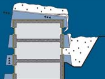
09| Dvouplášťová větraná obalová konstrukce budovy s kombinovaným sklonem vnějšího pláště (strmá a plochá část)
