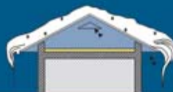
06| Dvoupplášťová větraná šikmá střeška sedlového tvaru s půdním prostorem odvodňovaná žlaby nebo přímým okapem vody na terén
