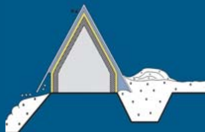
20| Dvouplášťová větraná strmá střecha (obalová konstrukce budovy) s možným skluzem sněhu
