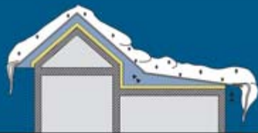
12| Seskupení šikmé větrané střechy sedlového tvaru a ploché větrané dvouplášťové střechy pultového tvaru na jedné budově s přímým spojením vrstev
