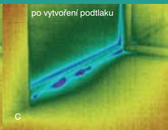
18| Dolní část francouzského okna v obývacím pokoji, patrné jsou výrazné netěsnosti v přípojovací spáře okna, které odpovídají přípojovacím kotvám.
