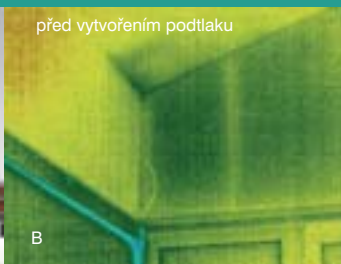
17| Horní část francouzského okna v obývacím pokoji, patrná je pouze malá netěsnost v přípojovací spáře okna.
