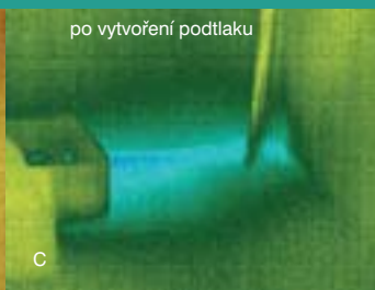
18| Dolní část francouzského okna v obývacím pokoji, patrné jsou výrazné netěsnosti v přípojovací spáře okna, které odpovídají přípojovacím kotvám.
