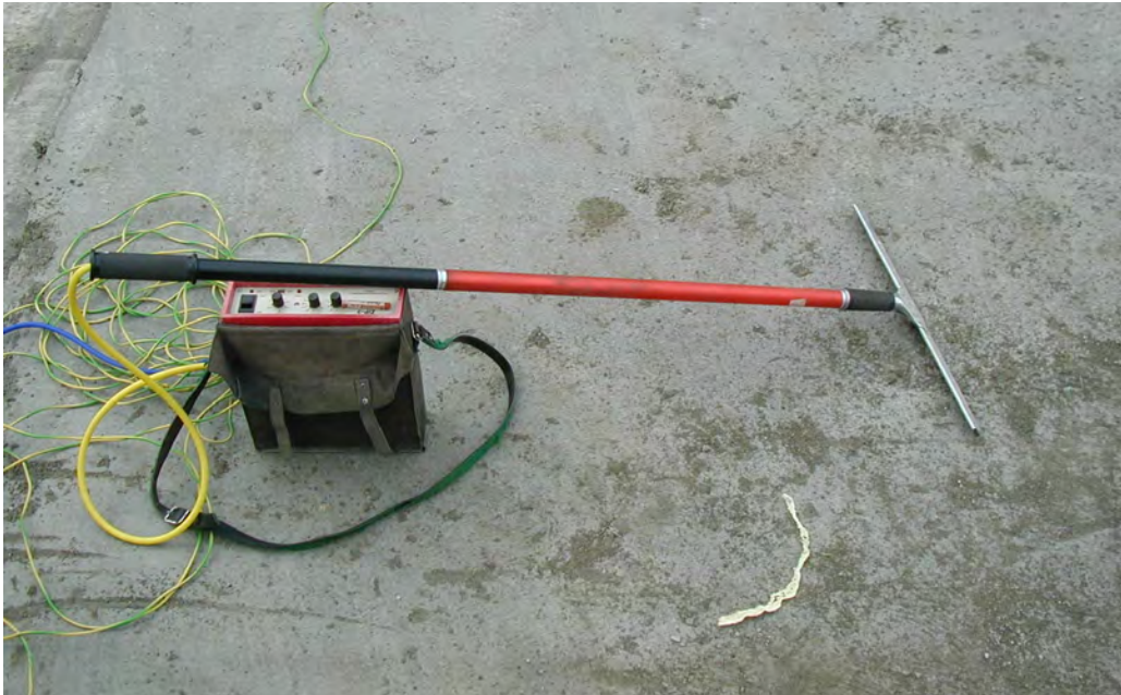
Foto 8. Poroskop - přístroj pro provádění jiskrové zkoušky.
