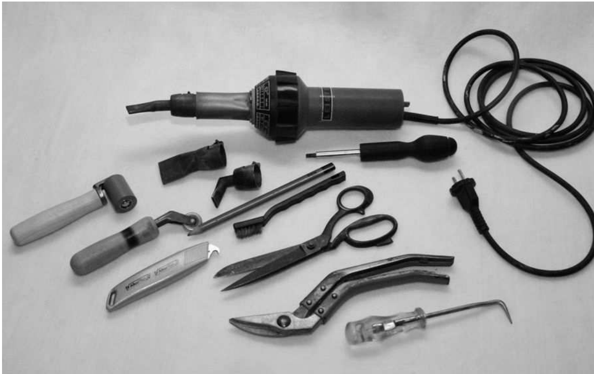
Obrázek 5.: Základní nástroje pro provádění hydroizolací z fólií DEKPLAN
