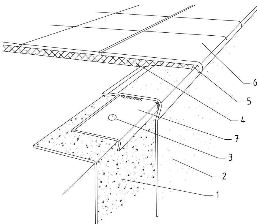
**Schéma 4. Okraj bazénu s fólií kotvenou na poplastovaný L profil.** 1 – textilie FILTEK, 2 – fólie ALKORPLAN, 3 – zatloukací nýt, 4 – lepidlo na dlažbu, 5 - spárovací tmel, 6 – dlažba, 7 – profil L 60/20 z poplastovaného plechu.
