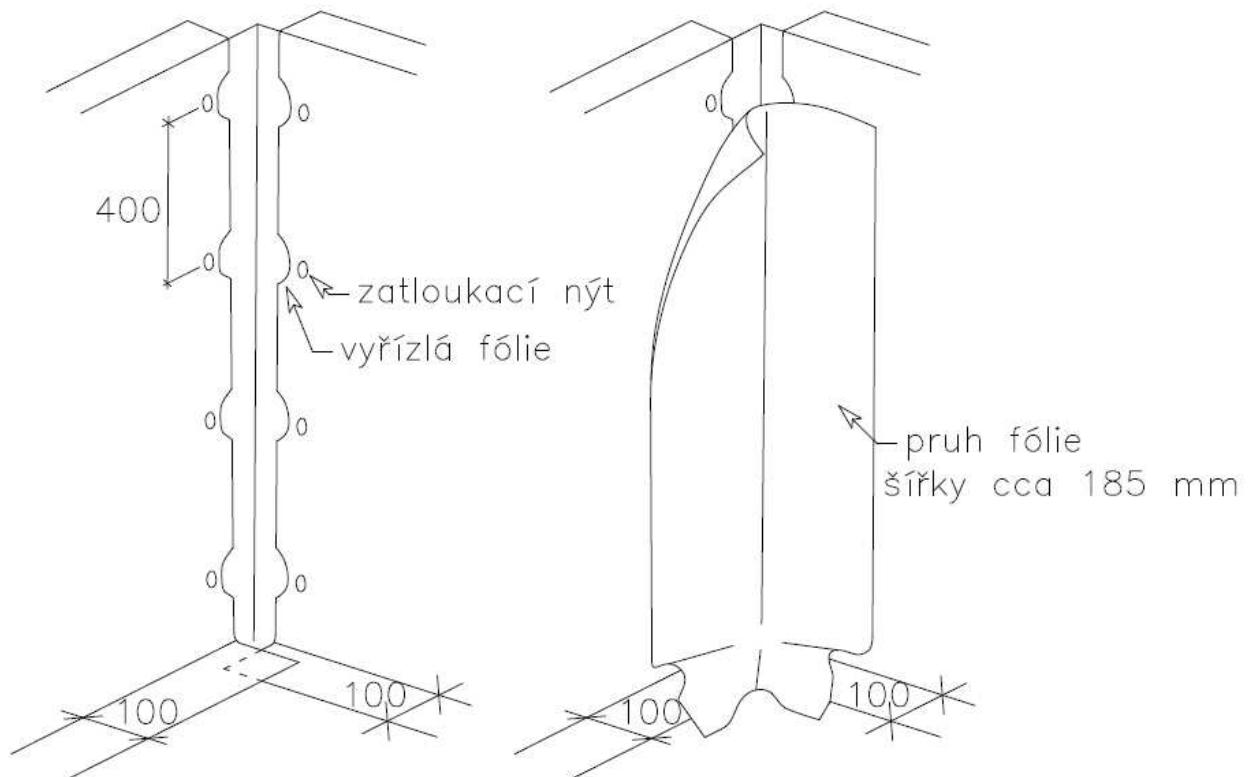
**Schéma 7. Napojení fólií v koutě pomocí pásu fólie.**
