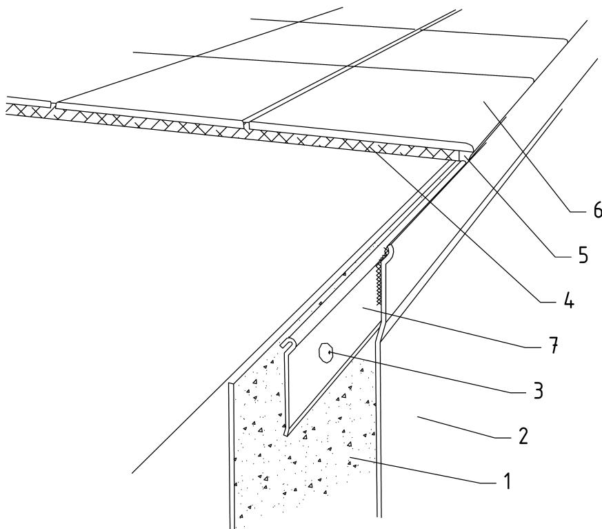
**Schéma 5. Okraj bazénu s fólií kotvenou na stěnovou lištu.** 1 – textilie FILTEK, 2 – fólie ALKORPLAN, 3 – zatloukací nýt, 4 – lepidlo na dlažbu, 5 - spárovací tmel, 6 – dlažba, 7 – stěnová lišta z poplastovaného plechu.
