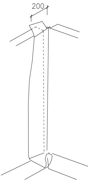
**Schéma 6. Napojení fólií v koutě.**
