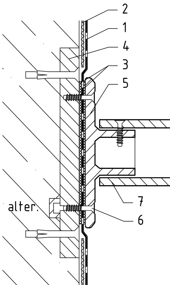
**Schéma 23. Schéma upevnění zábradlí.** 1 - fólie ALKORPLAN, 2 – textilie FILTEK, 3 – těsnění ze silikonové pryže, 4 – pevná příuba, 5 – volná příuba, 6 – šroub, 7 – zábradlí. Všechny kovové prvky jsou vyrobeny z nerezové oceli.
