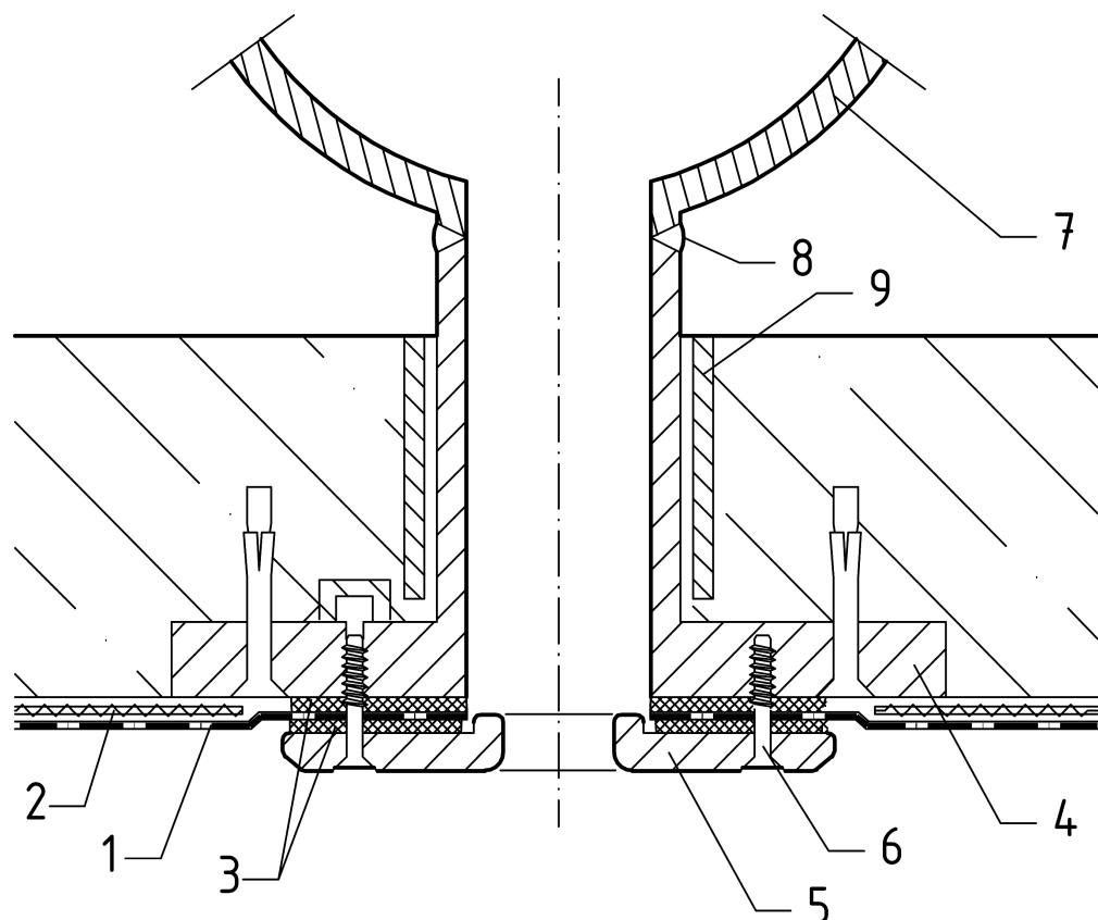
**Schéma 24. Schéma přívodu vody při rekonstrukci bazénu.** 1 - fólie ALKORPLAN, 2 – textilie FILTEK, 3 – těsnění ze silikonové pryže, 4 – pevná příruba, 5 – volná příruba, 6 – šroub, 7 – původní potrubí, 8 – vodotěsný svár, 9 – původní potrubí fungující jako chránička. Všechny kovové prvky jsou vyrobeny z nerezové oceli.
