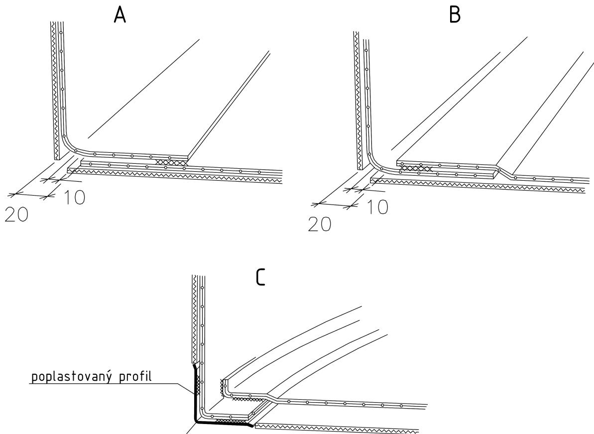
**Schéma 13. Různé způsoby napojení stěny na dno.** A – případ pro bazény s přímými stěnami, fólie dna je podsunuta pod fólii ze stěny; B – způsob vhodný pro bazény přímé i zaoblené, dno překrývá fólii ze stěny; C – varianta napojení stěny a dna oblých bazénů s koutovou lištou.
