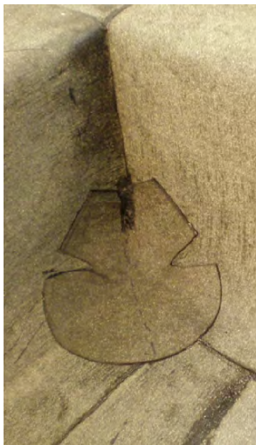
Obrázek /11/ Natavení univerzální tvarovky 3 a 2 bez posypu a koutové tvarovky 2
