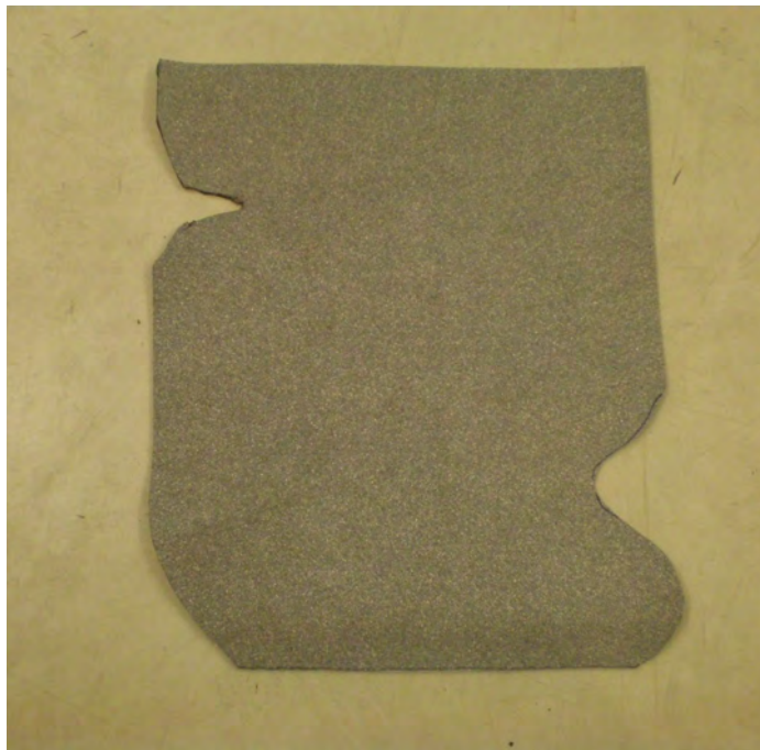
Obrázek /18/ Speciální tvar asfaltového pásu na atice mezi vnitřním koutem a vnějším rohem
