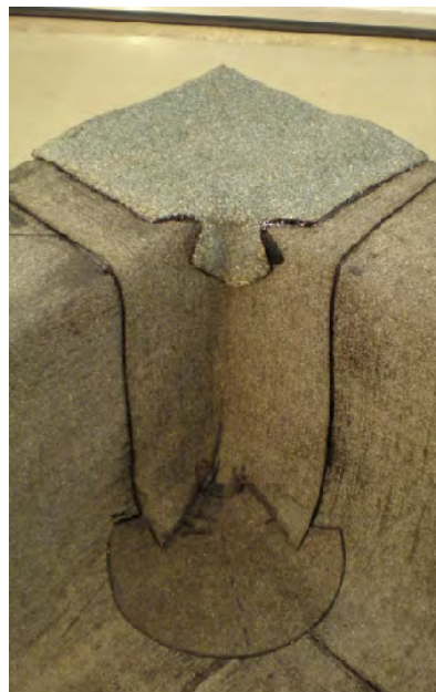
Obrázek /11/ Natavení univerzální tvarovky 3 a 2 bez posypu a koutové tvarovky 2
