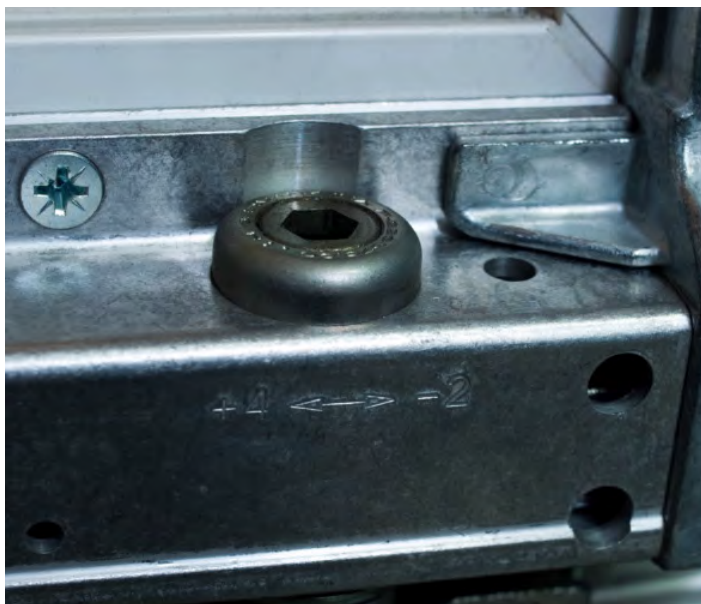
Foto 48 – servisní šroub na vozíku spodního pojezdu
