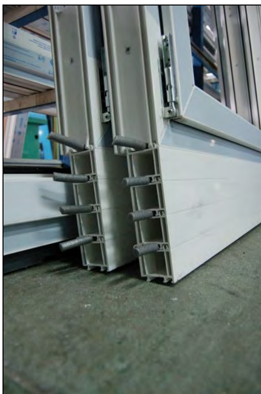
Foto 74 – Sestava z podkladních profilů pod prahem balkonových dveří
