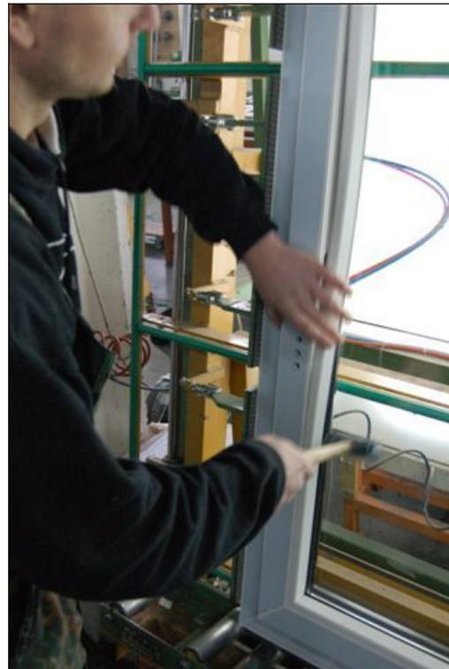
**Foto 57 – Montáž svislé zasklívací lišty**
