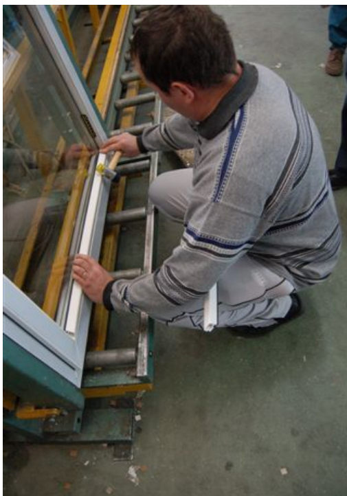
Obr. 98 – Osazení vodorovné zasklívací lišty
